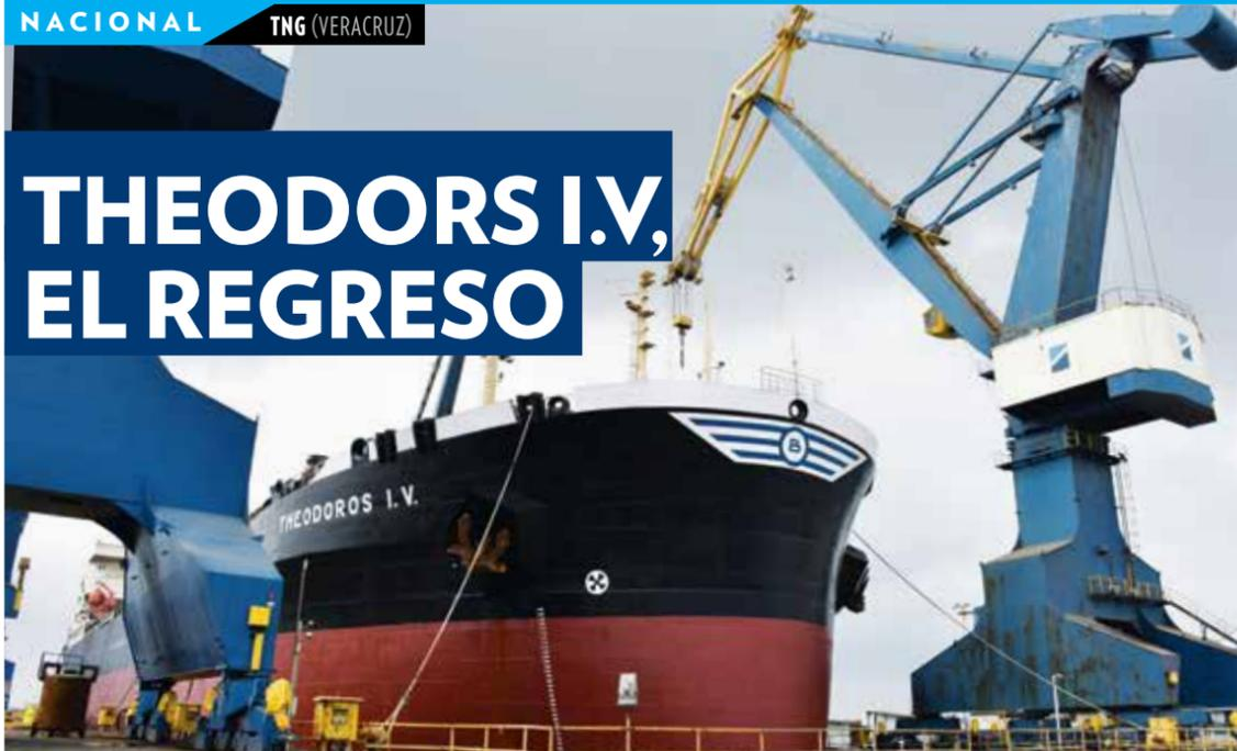
**T**ras su visita al Astillero en el año 2017, Theodors I.V., embarcación de 182.7 m de eslora y con bandera de Grecia, regresó para una renovación de acero, limpieza y pintura de tanques de lastre como ruta crítica. Además, durante su estadía recibió trabajos de carenado general, como limpieza y pintura de casco, y mantenimiento al sistema de propulsión.
